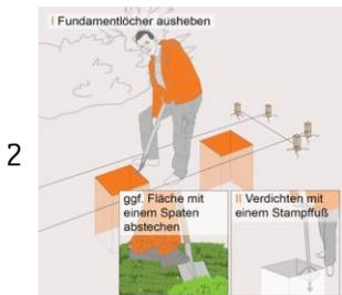
Falls vorhanden, entfernen Sie zunächst die Grasnarbe. Danach heben Sie Fundamentlöcher mit einer Breite und Länge von ca. 40 cm und einer Tiefe von ca. 80 cm (von der Oberkante des Grabens gemessen) aus. Verdichten Sie den Untergrund. Falls der Boden sehr sandig ist, setzen Sie eine Schalung aus Brettern, damit die Löcher nicht einstürzen können. Die Fundamente sollten später ca. 10 cm unter Belagsoberkante enden.
