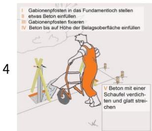
Füllen Sie eine 5 bis 10cm starke Betonschicht in das Fundamentloch und verdichten Sie diesen. Stellen Sie den Gabionenpfosten in das Fundamentloch. Fixieren Sie die Gabionenpfosten mittels Holzleisten und betonieren Sie diese ein. Füllen Sie dazu das Fundamentloch bis auf ca. 10 cm unter der Belagsoberkante auf. Verdichten Sie den Beton dabei mit einer Schaufel und streichen Sie ihn glatt.
