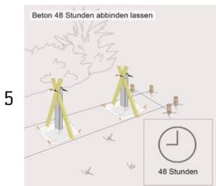
Lassen Sie den Beton ca. 48 Stunden lang abbinden/ruhen. Sollten Sie eine Schalung gesetzt haben, können Sie diese nach der Abbindezeit heraus nehmen. Um Zeit zu sparen, können Sie ggf. zum nächsten Projekt übergehen.
