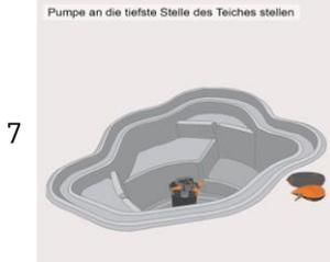
Legen Sie die Pumpe an die tiefste Stelle Ihres Teiches. Damit wird eine ausreichende Zirkulation des Wassers ermöglicht.
