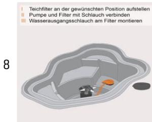
Stellen Sie den Teichfilter an der gewünschten Position auf. Achten Sie darauf, dass die maximale Förderhöhe der Pumpe nicht überschritten wird und der Filter für Wartungsarbeiten zugänglich ist. Verbinden Sie die Pumpe und den Filter mit einem passenden Schlauch. Zum Schluss montieren Sie den Wasserausgangsschlauch am Filter und führen so das Wasser zurück in den Teich.
